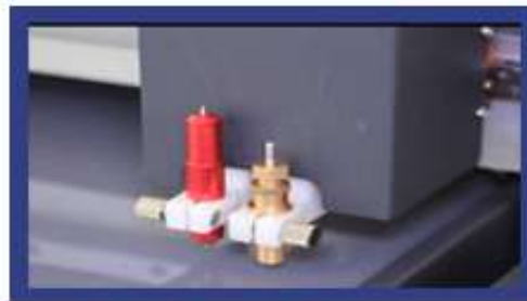
Double Head Cutter untuk pengerjaan Kiss Cut, Die Cut dan Creasing
