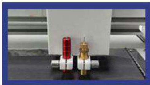
Cutting and Creasing Processing , dilengkapi dengan dua kepala agar dapat memotong dan creasing bersamaan
